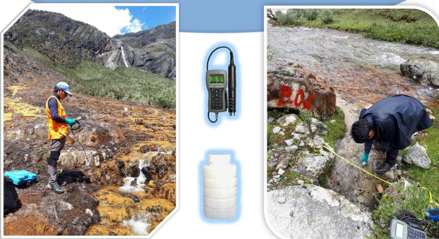
Figura N° 02: Evaluación en el punto Q-04, en que se presenta el Drenaje Ácido de Roca, y colecta de muestras de agua en campo.
